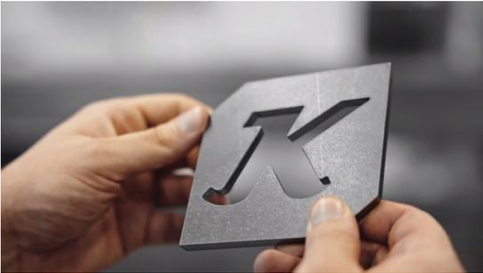
**Bild:** Optimale Schneidergebnisse bis 60 mm mit der Plasmastromquelle K 200 von Kjellberg Finsterwalde (© Foto: Kjellberg Finsterwalde)
