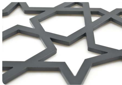
Hohe Schnittqualität hinsichtlich Konturtreue und Rechtwinkligkeit an Innen- und Außenkonturen High cut quality with regard to contour accuracy and rectangularity on inner and outer contours
